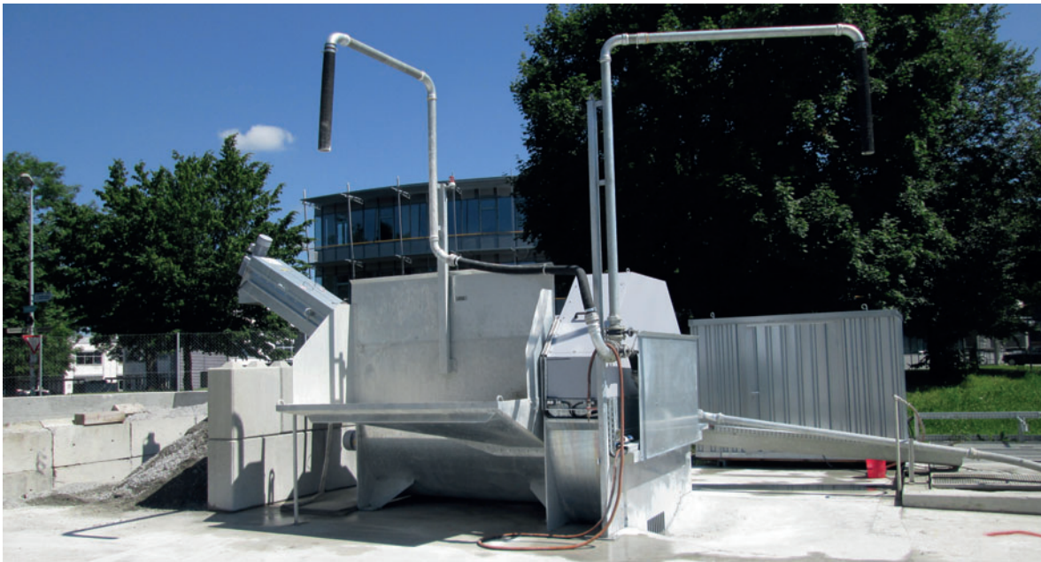
Die Transportbeton Leutkirch – Isny GmbH & Co. KG investierte im Werk Leutkirch in eine neue Recyclinganlage der Firma Bibko mit Auswaschoption für Betonpumpen.
