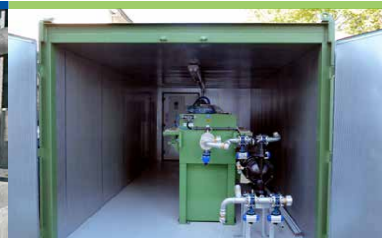
Kammerfilterpresse als mobile Lösung im Container Filter Press as a mobile container solution
