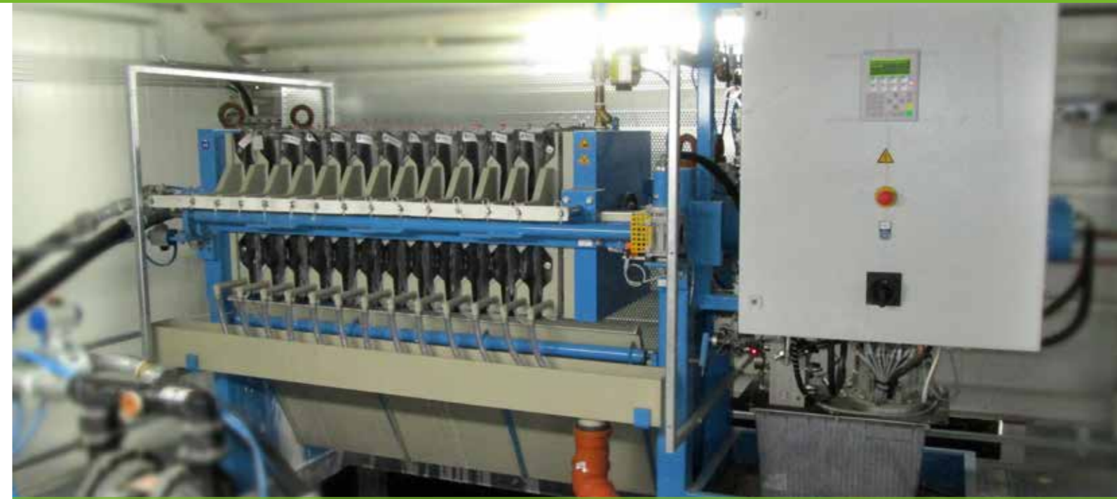
Kammerfilterpresse als mobile Lösung im Container Filter Press as a mobile container solution
