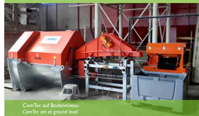
ComTec mit Kübelbahnentleerung ComTec with bucket conveyor discharge
