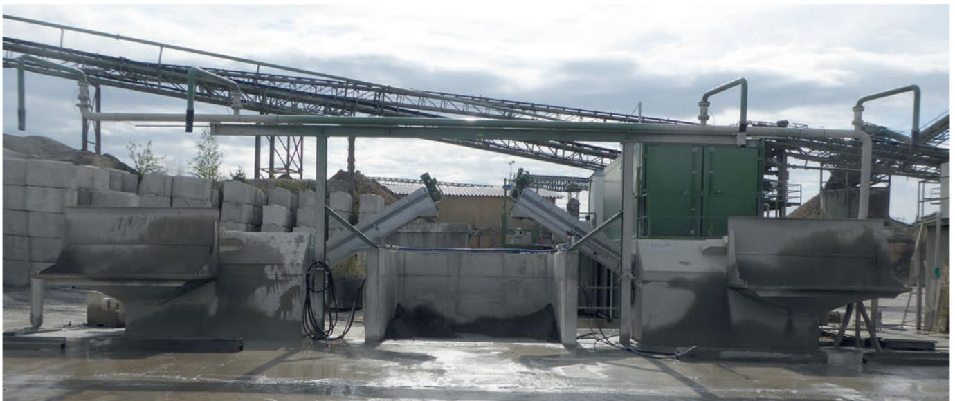
*Das ausgearbeitete Konzept beinhaltet zwei Recyclingmaschinen inkl. Rührwerken sowie einer Kammerfilterpresse.*
