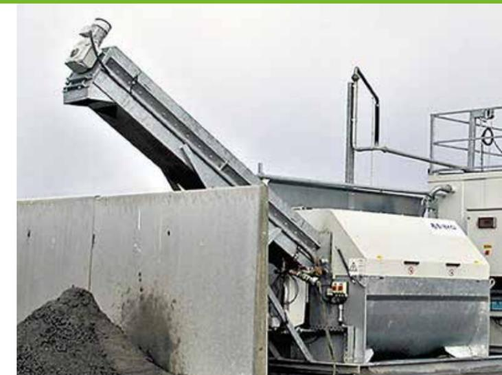
Version I: Mobile ComTec auf Stahlträger montiert
