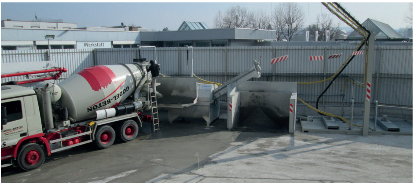
La instalación ComTec 20 suministrada ofrece una capacidad de reciclaje de 20 m 3 /h.
