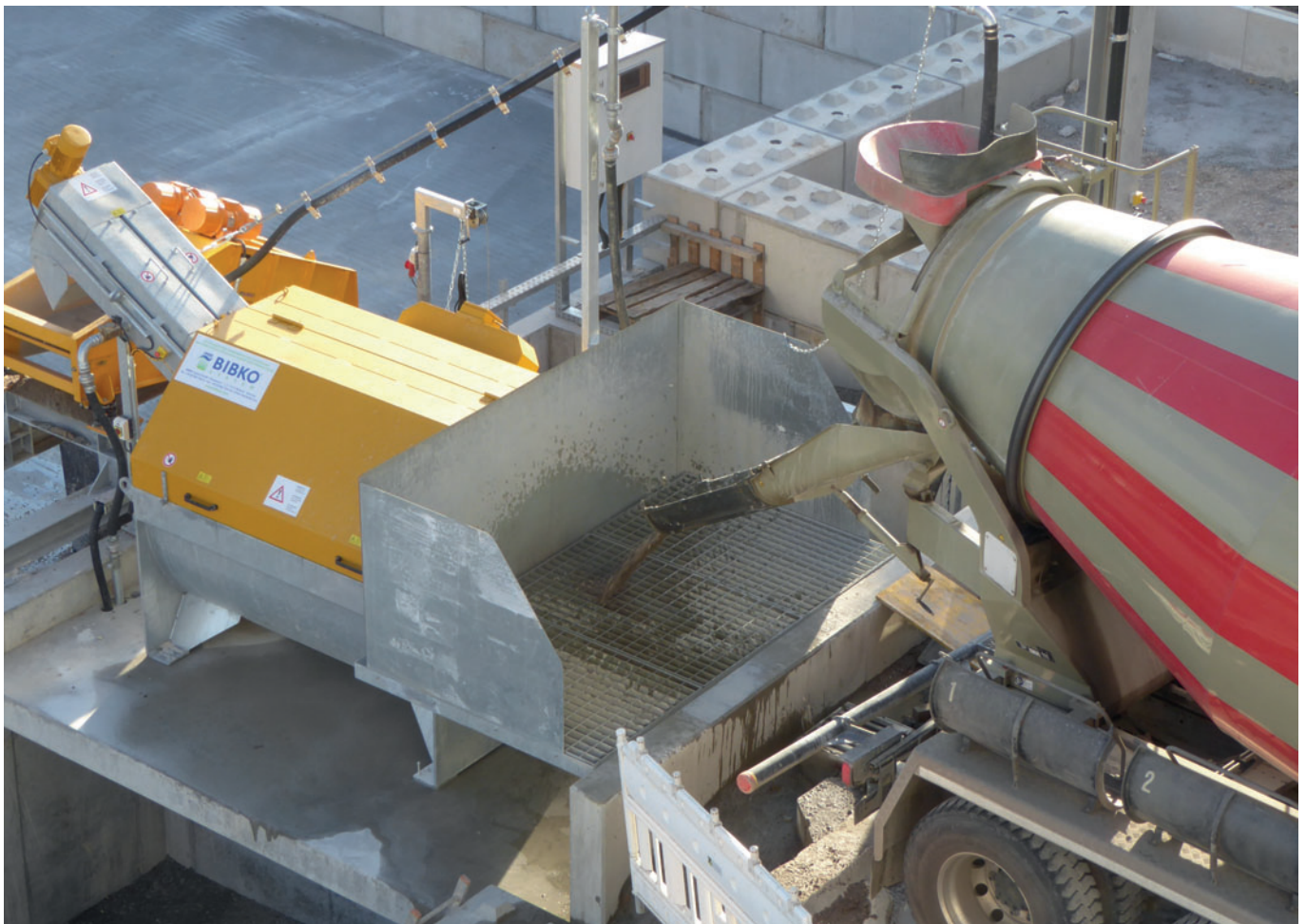
Le système de recyclage fourni de type ComTec 20 permet des capacités de recyclage de 20 m 3 /h.
