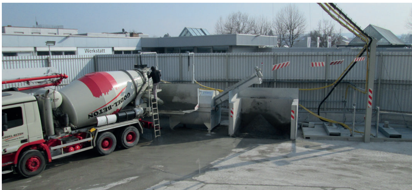
Le système de recyclage fourni de type ComTec 20 permet des capacités de recyclage de 20 m 3 /h.
