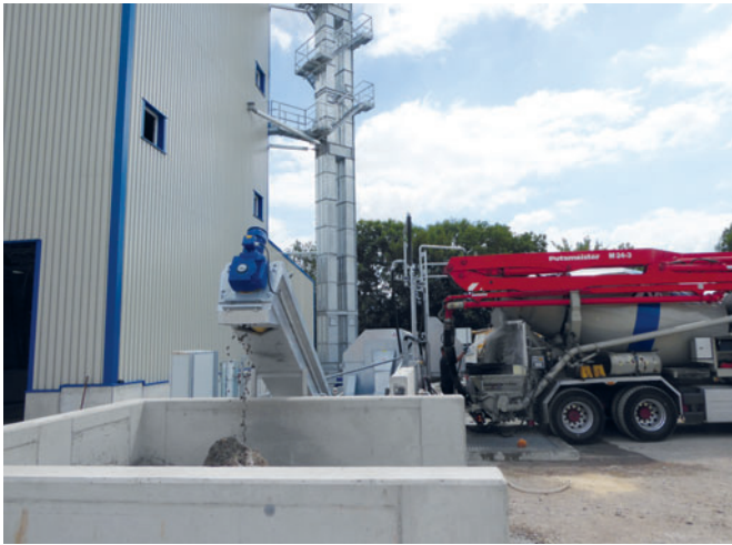
Le système de recyclage fourni ComTec30 offre un débit de recyclage de 30 m 3 /h.
